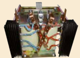
Gehäuse mit Geräten Single phase supplier 10 kW
