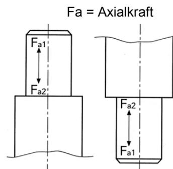
Fa1 = Fa<sub>pull</sub> Axialkraft aus Motor heraus
