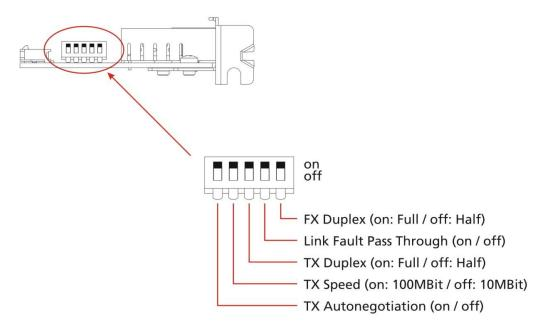
Achtung! DIP-Switch Konfiguration nur im stromlosen Zustand durchführen
