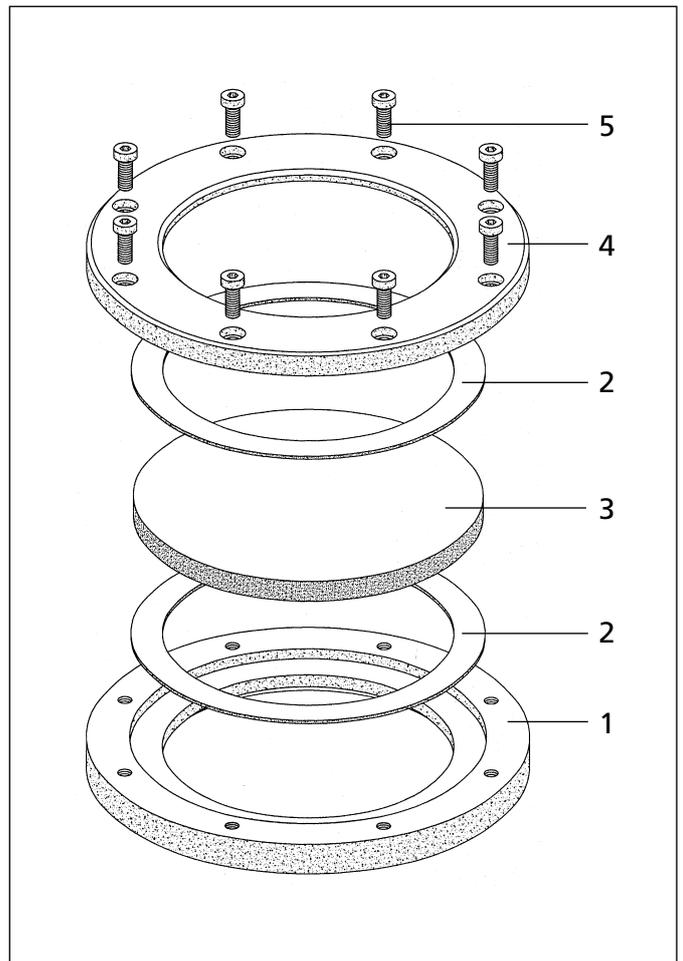
Aufbau einer Lumiglas Schauglas-Armatur aus Edelstahl
