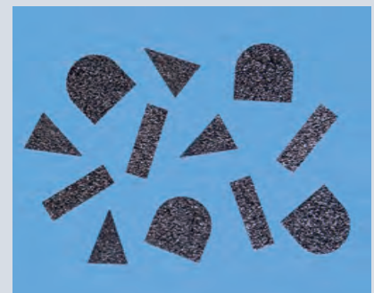
Bild 11: Diamantqualitäten, links: Naturdiamant/West-Afrika/ungebrochen, Mitte: Naturdiamant/West-Afrika/form-gesiebt, rechts: CVD Diamant-Segmente
