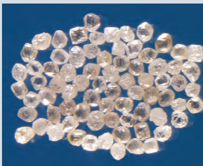
Bild 11: Diamantqualitäten, links: Naturdiamant/West-Afrika/ungebrochen, Mitte: Naturdiamant/West-Afrika/form-gesiebt, rechts: CVD Diamant-Segmente
