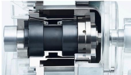
Über eine Magnetkupplung wird die Pumpenleistung berührungsfrei von der Antriebswelle übertragen. Diese Konstruktion bewirkt, dass die Pumpendrehzahl stets der Antriebsdrehzahl entspricht. Durch die besondere Lagerung des Innenrotors der Magnetkupplung wird ausschließlich das Drehmoment übertragen. Unerwünschte Kräfte auf die Antriebswelle werden vermieden.
