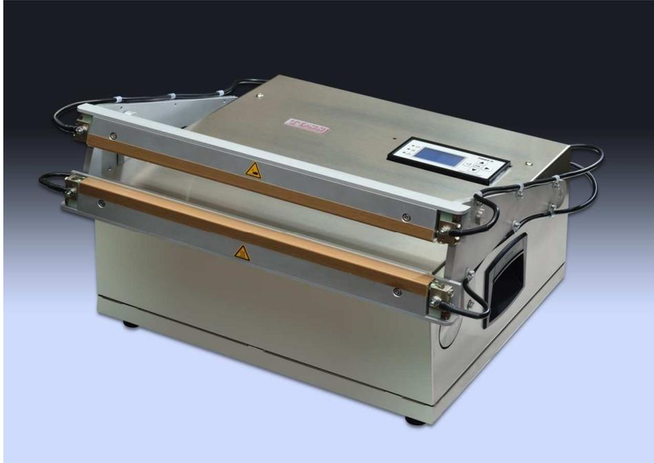
Als Weiterentwicklung verfügt die neue Serie jetzt über ein kompaktes Edelstahlgehäuse. Das Antriebskonzept ist für höchste Anforderungen ausgelegt und erzeugt ein spezielles Bewegungsprofil: Die Schienen schließen stets mit auf Schweißtemperatur aufgeheizten Impulsbändern. Optimale Nahtergebnisse auch bei empfindlichen Folien sind die Folge.
