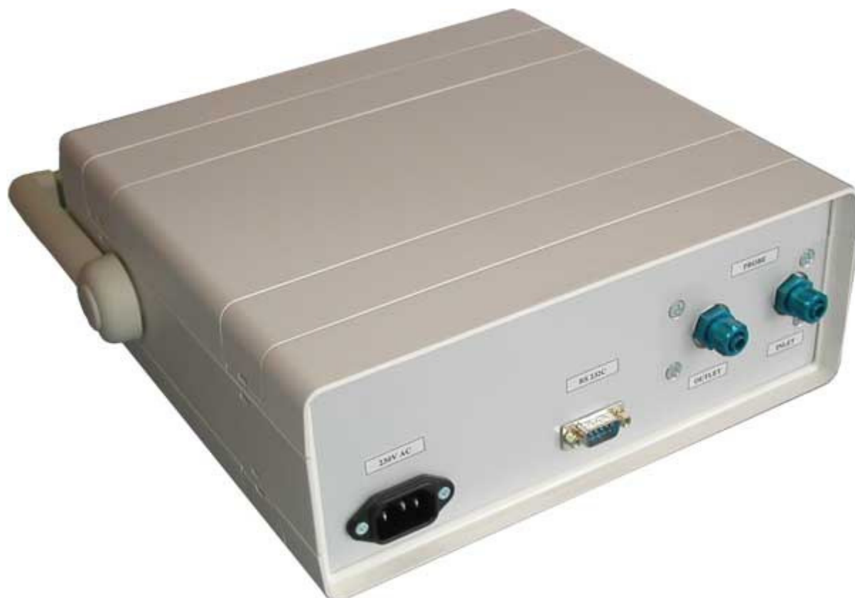
Pohled na zadní stranu hygrometru řady HG 111 se vstupním a výstupním šroubením FESTO pro měřené plyny
