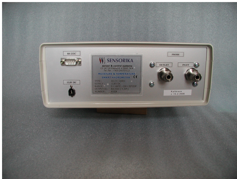
Pohled na zadní stranu hygrometru HG 311-00001 se vstupním a výstupním šroubením Swagelok
