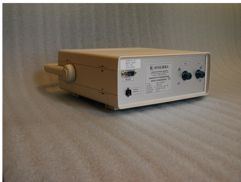
Pohled na zadní stranu hygrometru HG 311-00001 se vstupním a výstupním šroubením Festo
