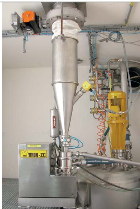
YTRON-ZC mit Pulverbeschickung aus Silo Aufgabenstellung: Gewürzsuspensionen
