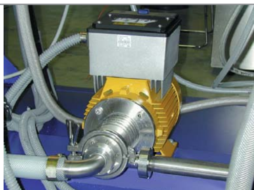
YTRON-Z mit angebautem Frequenzumformer Aufgabenstellung: Kontinuierliche Herstellung von Stammverdickungen in der Textilindustrie
