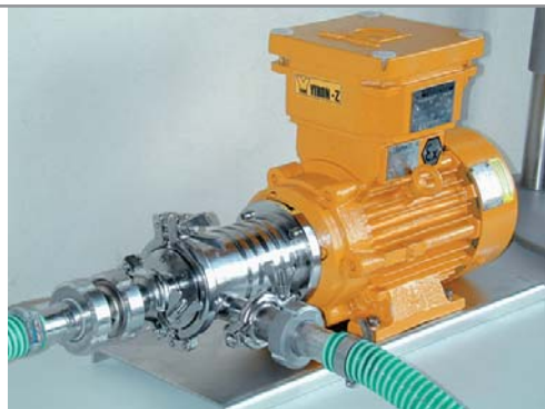
YTRON-Z mit Motor in EX-Ausführung Aufgabenstellung: Vielfältige Anwendung im Laborbereich
