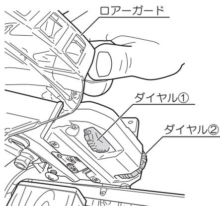
5. ダイヤル①とダイヤル②を交互に回転させながら、材料の切断面とレーザーラインを合わせます。
