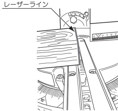
6. レーザーラインの位置を調整後、材料に直角な墨線を引き、レーザーラインに墨線を合せます。墨線を合せる場合、材料を少しずつずらし、墨線にレーザーラインが重なる位置でクランプにより固定します。再び切断して、レーザーラインの位置を確認します。
