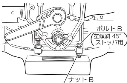
4. 回転テーブルとノコ刃の側面に三角定規をあて、ボルト B を右に回して回転テーブルとノコ刃が  $45^{\circ}$  になるように調整します。
