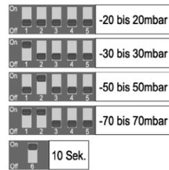
Der Dipschalter-Nr. 6 dient als Filter für die Stabilisierung des Druckmesssignals. In OFF-Stellung findet eine Abfrage im Zeitintervall von 1 Sekunde statt. In ON-Stellung wird das Abfrageintervall auf 10 Sekunden erhöht und somit das Signal geglättet.
