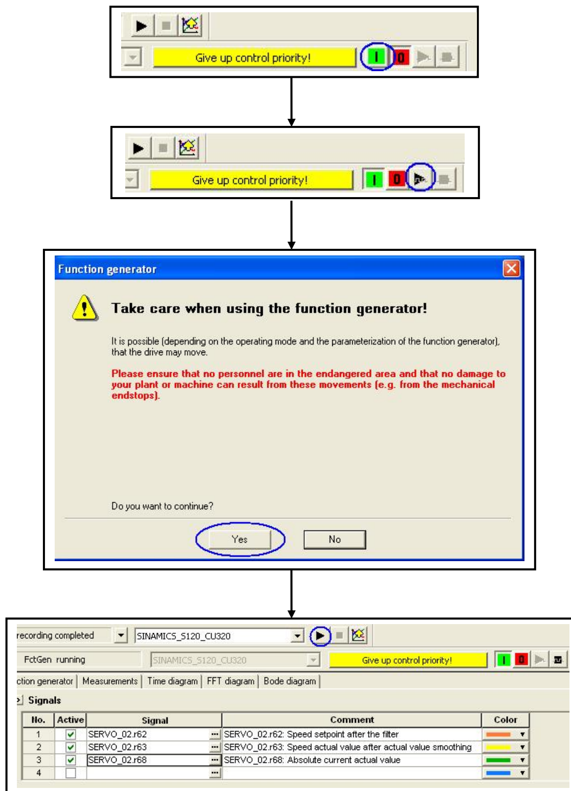
图 3.23 启动函数发生器记录 Trace 曲线
