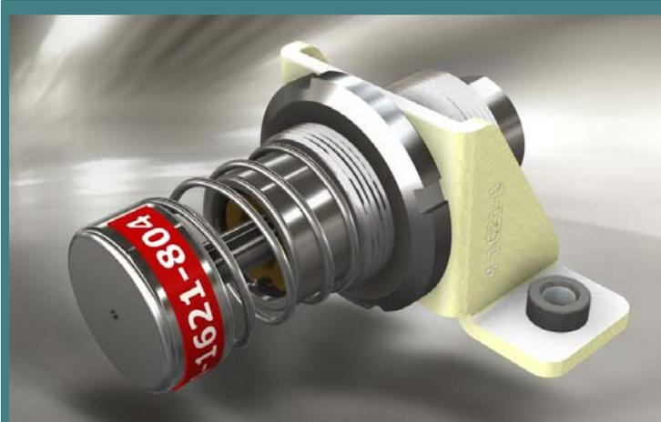
Il fluido idraulico presente nella camera, verrà quindi forzato a transitare dalla strozzatura presente nel pistone idraulico generando la forza frenante di reazione che innalzerà la pressione nella camera idraulica dell'ammortizzatore.
